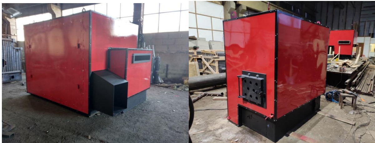
Блок котла в легкой обмуровке
