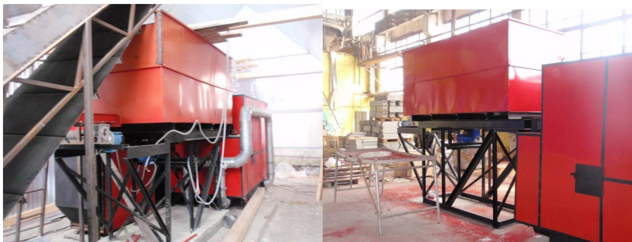
Система топливоподачи с оперативным бункером V=3м3
