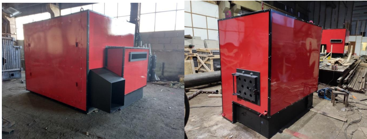
Блок котла в легкой обмуровке
